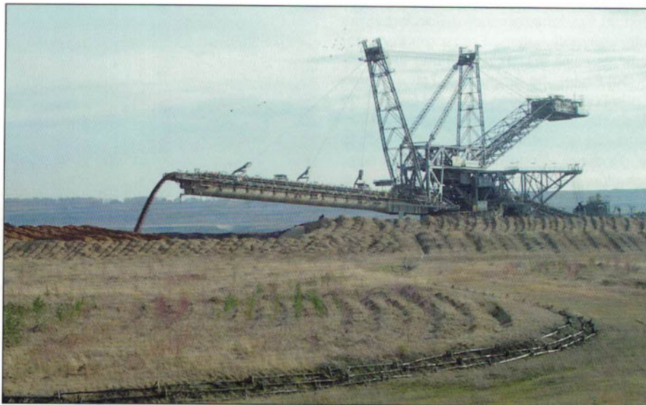
6 Der Absetzer 737 beim Ankippen der Uferböschung; im Vordergrund das noch trockene Indebett
